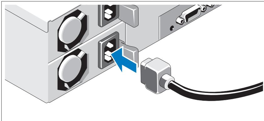
Podłącz odpowiedni kabel (lub kable) zasilania do systemu oraz do monitora, o ile używasz monitora. Podłącz drugą końcówkę kabli do uziemionego gniazdku elektrycznego lub oddzielnego źródła zasilania, np. do zasilania bezprzerwowego (UPS) lub do jednostki rozdziału zasilania (PDU).
