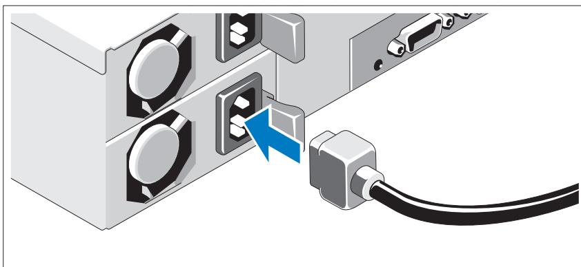
Verbinden Sie die Netzstromkabel mit dem System sowie gegebenenfalls mit dem Bildschirm. Verbinden Sie das andere Ende des Kabels jeweils mit einer geerdeten Steckdose oder mit einer separaten Spannungsquelle, etwa einer unterbrechungsfreien Stromversorgung (USV) oder einem Stromverteiler (PDU).
