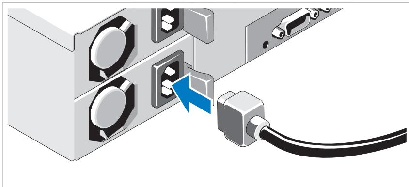
Conecte los cables de alimentación al sistema y, si se utiliza un monitor, conecte el cable de alimentación correspondiente al monitor. Conecte el otro extremo de los cables de alimentación a una toma eléctrica con conexión a tierra o a otra fuente de alimentación, como por ejemplo un sistema de alimentación ininterrumpida (SAI) o una unidad de distribución de alimentación (PDU).
