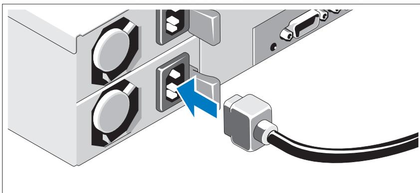
Sistemin güç kablosunun/kablolarının sisteme bağlantısını yapın ve bir monitör kullanılıyorsa, monitörün güç kablosunun monitöre bağlantısını gerçekleştirin. Güç kablolarının diğer ucunu topraklı bir elektrik prizine ya da kesintisiz güç kaynağı (UPS) veya güç dağıtım birimi (PDU) gibi ayrı bir güç kaynağına takın.
