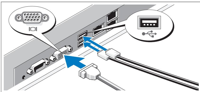
Подключите клавиатуру, мышь и монитор (дополнительно).
