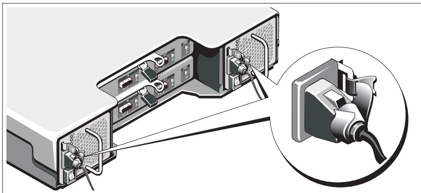
Tekuk kabel daya sistem seperti terlihat pada gambar dan kencangkan kabel dengan benar pada braket menggunakan tali yang disediakan.
