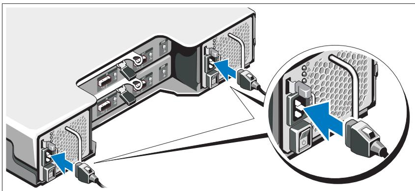
電源ケーブルに接続する前に、電源スイッチがオフになっていることを確認してください。システムに電源コードを接続します。
