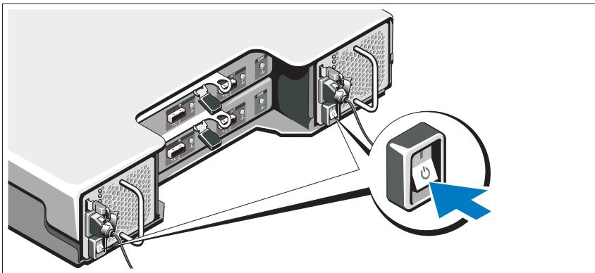
電源スイッチをオンになるように押します。電源インジケータが点灯します。
