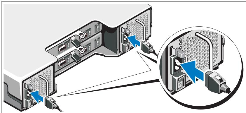
전원 케이블을 연결하기 전에 전원 스위치가 꺼짐 (OFF) 위치에 있는지 확인하십시오 . 시스템의 전원 케이블을 시스템에 연결합니다 .
