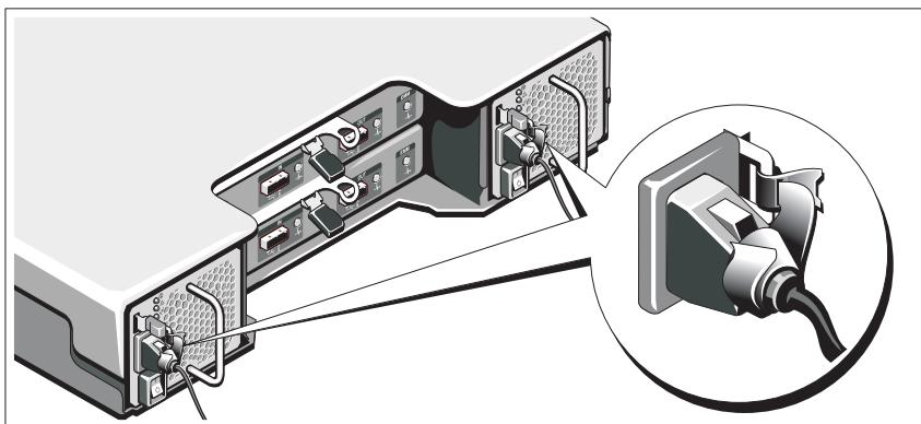
如图所示，将系统电源电缆弯曲成一个环路，并使用所提供的带子将其固定到支架。
