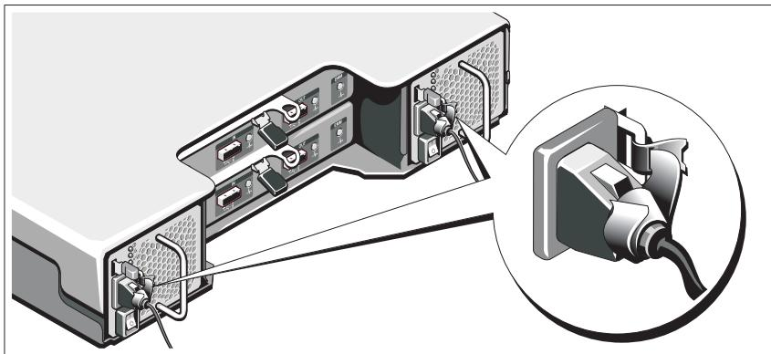
システムの電源ケーブルを図に示してあるように曲げ、付属のストラップを使ってケーブルをプラケットにしっかりと固定します。
