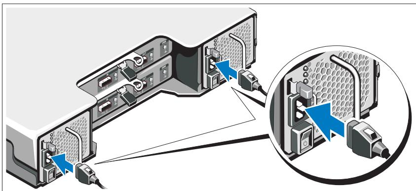
在连接电源电缆之前确保电源开关处于关闭位置。将系统的电源电缆连接到系统上。
