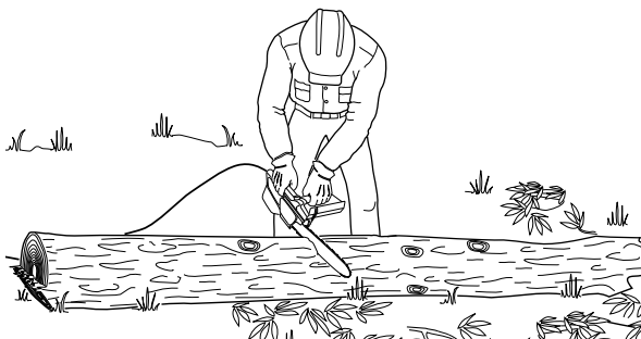
Figure 11 - Tronçonnage d'une bille qui repose entièrement au sol
