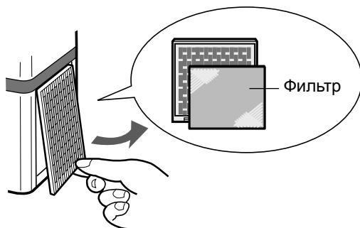
\* Фильтр предназначен для многоразового использования, его нужно часто очищать.
