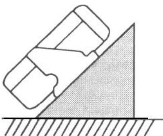
Der Einbau in einem Winkel von 45° ist nicht möglich, wenn nur **(A)** verwendet wird.
