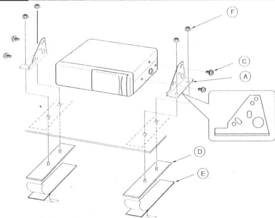
Vertikaler Einbau . Vertical installation . Installation verticale . Instalación vertical . Montaggio verticale .
