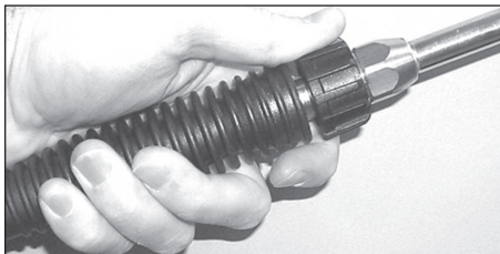
Figura 6 - Conecte la lanza a la pistola
