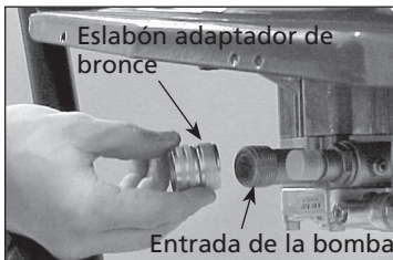
Figura 4 - Conecte el eslabón adaptador a la bomba
