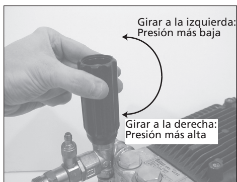
Figura 11 - Ajuste de la presión de la bomba de árbol de distribución
