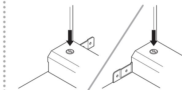
② 金具と側板の隙間に、SP-32に付属されている金具を差し込みます。
