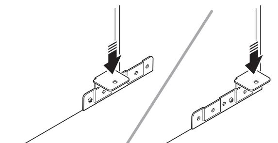
⑦ ペダルの位置（高さ）を調整してから、手順3で仮留めしたネジをしっかりと締めます。
