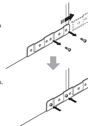
①-b 手順1-aで取り外したネジを使って金具を仮留めします。
