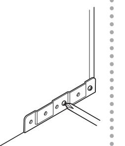
⑥ SP-32に付属のペダル取付用ネジでしっかりと固定します（2箇所）。
