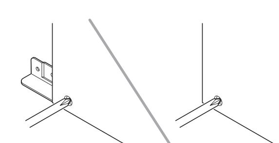
③ 側板の外側から、SP-32に付属されているネジを使って仮留めします。
