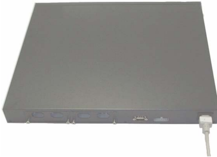
図 1-2 電源ケーブルの接続
