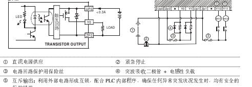
1. 輸入 / 入點端子請使用 O 型或 Y 型端子，端子規格如左所示。PLC 端子螺絲扭力為 5 ~ 8 kg-cm (4.3 ~ 6.9 in-lbs)，只能使用 60/75°C 的動力線。
