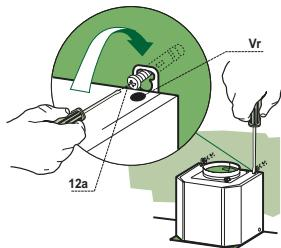
**Note:** Le corps de la hotte devrait être fixer au poteau mural. Si nécessaire, installer un support en bois derrière la paroi sèche, à mi-chemin entre deux poteaux muraux. Cela fournira la structure et le soutien nécessaire au montage.
